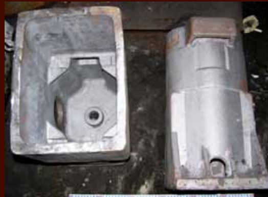
Компоненты дорожно-строительной техники, отлитые методом ЛГМ
