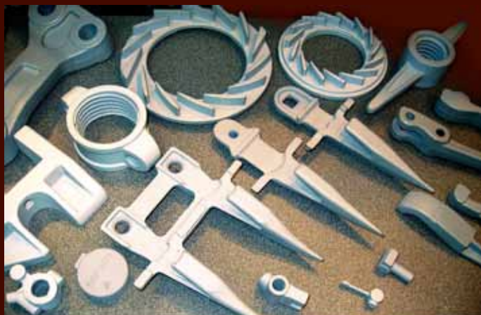
Компоненты дорожно-строительной техники, отлитые методом ЛГМ
